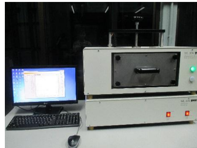
ภาพที่ 6. การทดสอบค่าการนำความร้อน
