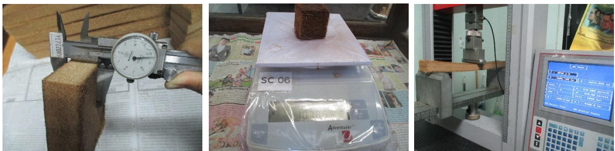
ภาพที่ 5. การทดสอบคุณสมบัติเชิงกลไม้ฉนวนตามมาตรฐาน JIS A 5905:2003
