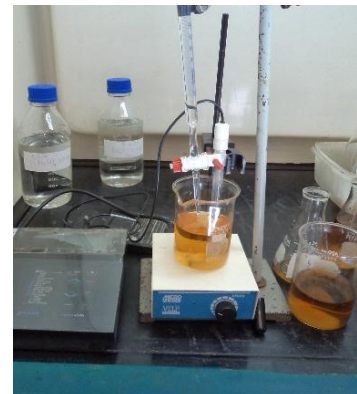
ภาพที่ 2. การทดสอบค่าความเป็นกรดเป็นด่างและการฟ่อนค่าความเป็นกรดเป็นด่าง
